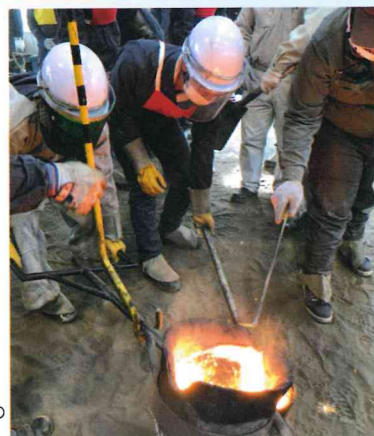
鳥栖工業高校機械科の キュボラ実習の様子
